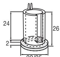
Absorber für „SILENCER“ Typ B (mit 2 Zapfen)
