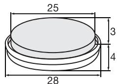
Einsatz „DUO“ ULTRASOFT/HYPER zum Eindrücken in jede passende Basis – wendbarer Gleiteinsatz
