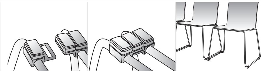
Basis „STRING“ zum Einpressen/Anschrauben an z.B. Rundrohre
