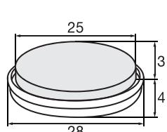
Einsatz „DUO“ ULTRASOFT/STOPP zum Eindrücken in jede passende Basis – wendbarer Gleiteinsatz
