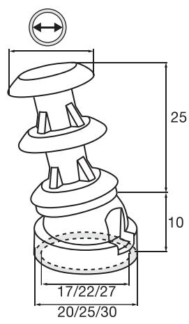
Basis mit Gelenk und abgesetztem Kopf zum Einsticken in Rundrohre
