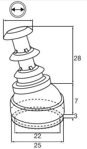
Basis „SMART“ mit Gelenk und abgesetztem Kopf und Bund zum Einstcken in Rundrohre
