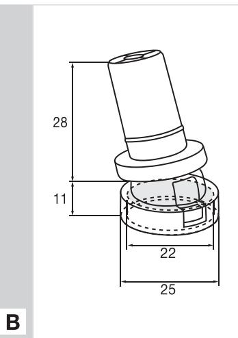
Basis „SILENCER“ mit Gelenk und abgesetztem Kopf zum Einsticken in passende Absorber
