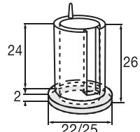
Absorber für „SILENCER“ Typ B (mit Zapfen)
